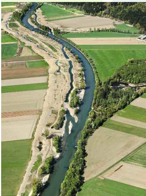
Die Drau bei Obergottesfeld in Kärnten vor ihrer Revitalisierung 2009 und rechts nach der Umgestaltung 2011. Das enge Korsett aus Ufersicherungen wurde auf einer Länge von 3 Kilometern entfernt. Stattdessen übernehmen verdeckt eingebaute Bühnen die Ufersicherung im Hochwasserfall.
